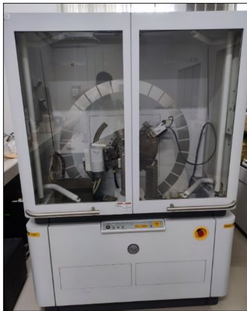
Figura 40. Difractómetro de rayos X.
